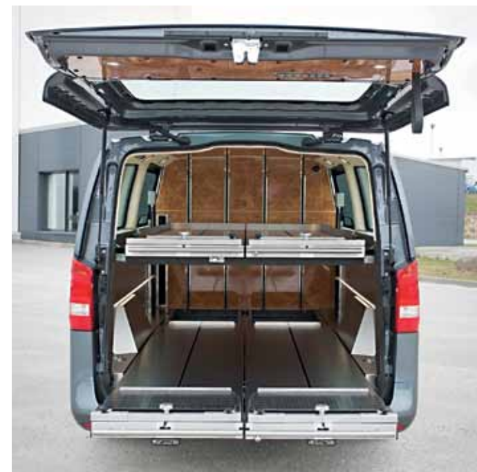
Vestavba pro převoz čtyř rakví se skládá ze železné konstrukce, ve které jsou uloženy dvě plošiny
