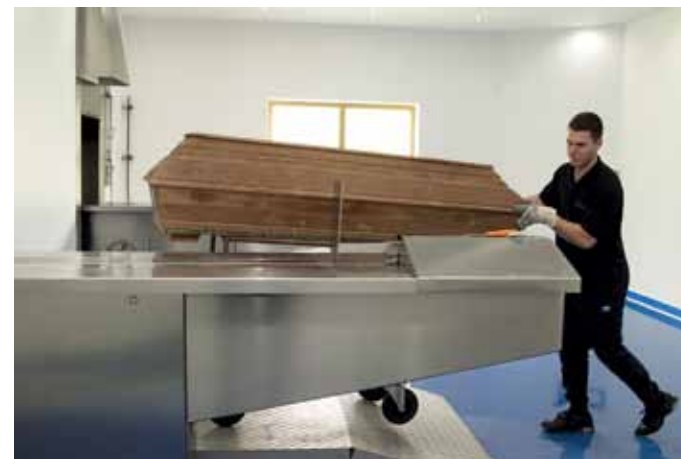
Krematorium Hustopeče, mechanismus zavážení do pece (foto Pavel Ondera)
