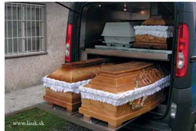
V České republice provozovatelé pohřebních služeb běžně používají pohřební automobily s úpravou na čtyři rakeve, hydraulika je posouvá nahoru dolů.
