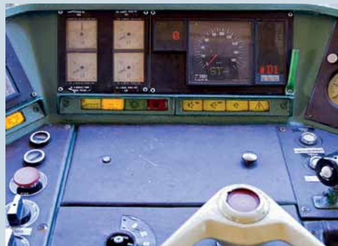
Palubovka elektrického rušňa Škoda 47E, radu 240 - Laminátky
